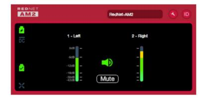
A ilustração acima mostra um RedNet AM2 com o Line Out Mute inativo e mostra o sinal presente em ambos os canais. Possui alimentação PoE disponível e conexão de rede bloqueada.
